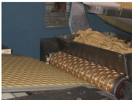
Εικόνα 4: Φαίνεται η δεξαμενή της ζύμης, το τύμπανο που αποτελεί το καλούπι των μπισκότων και την χαλύβδινη μεταφορική ταινία πάνω στην οποία τοποθετούνται τα μορφοποιημένα μπισκότα. (πηγή: W. P. Edwards (2007))
