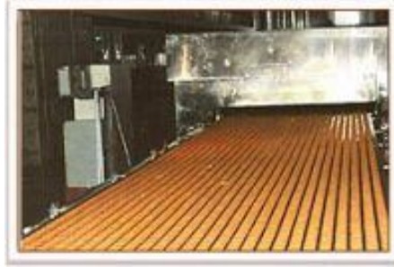
Εικόνα 5: Μεταφορική ταινία με ψημένα μπισκότα όπως εξέρχεται από τον φούρνο τούνελ.
