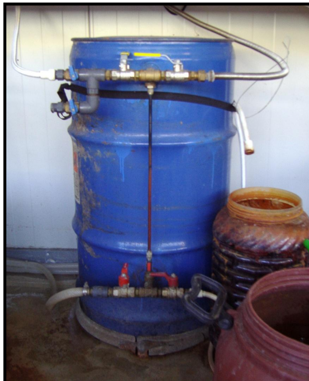
Εικόνα II.3. Φωτογραφία βαρελιού για την έμμεση μέτρηση της παραγωγής βιοαερίου
