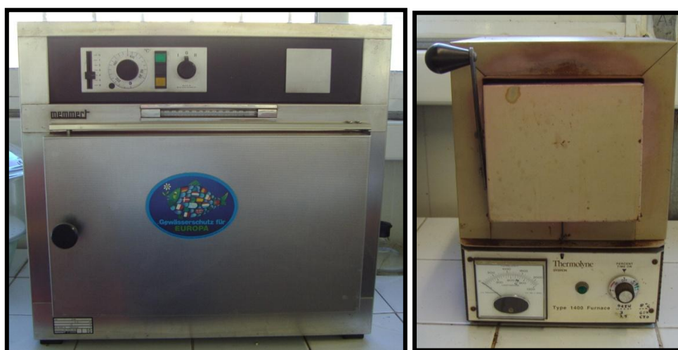
Εικόνα II.5 & II.6. Φούρνος ξήρανσης και αποτεφρωτήρας
