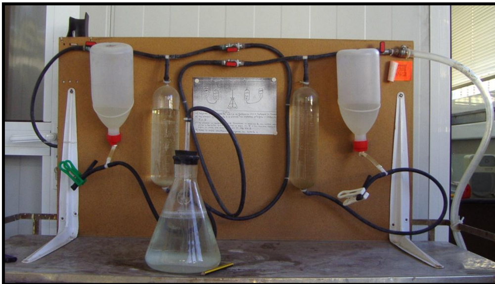
Εικόνα II.7. Διάταξη οργάνων για τη μέτρηση περιεκτικότητας μεθανίου στο βιοαέριο
