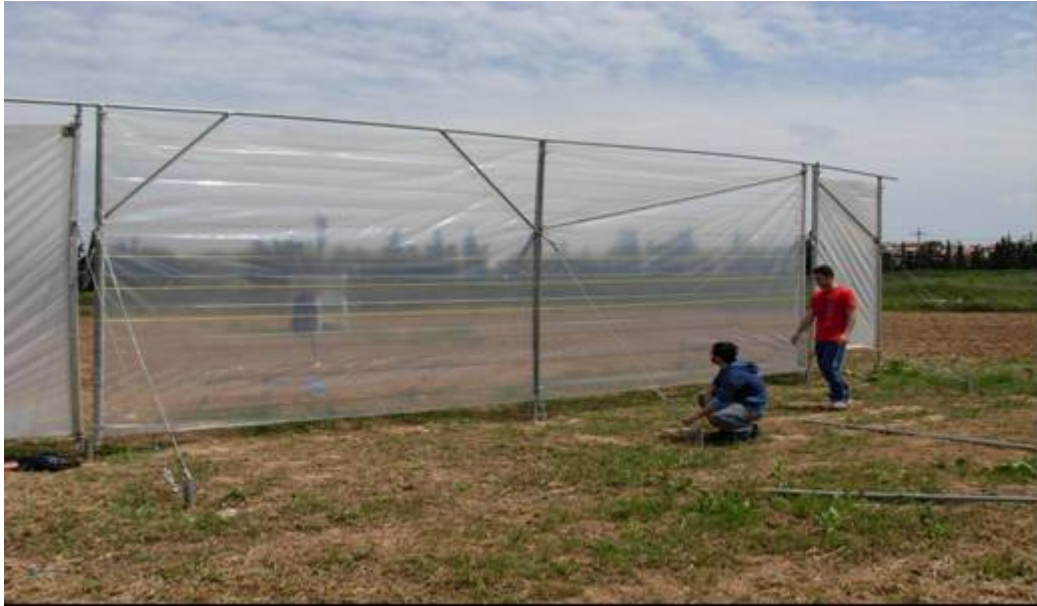
Εικόνα 25. Πλήρους κλίμακας πειραματική διάταξη πλαισίου με ελαστική στήριξη. Κάλυψη με μη περατό πλαστικό.
