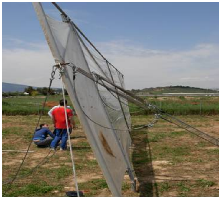
Εικόνα 28. Το πλαίσιο ελαστικής στήριξης. Χρήση των ελατηρίων για την επίτευξη κίνησης κατά την αλληλεπίδραση του πλαισίου με τον άνεμο και συρματόσχοινων για την στήριξη αλλά και αποφυγή πλαστικών παραμορφώσεων των ελατηρίων.
