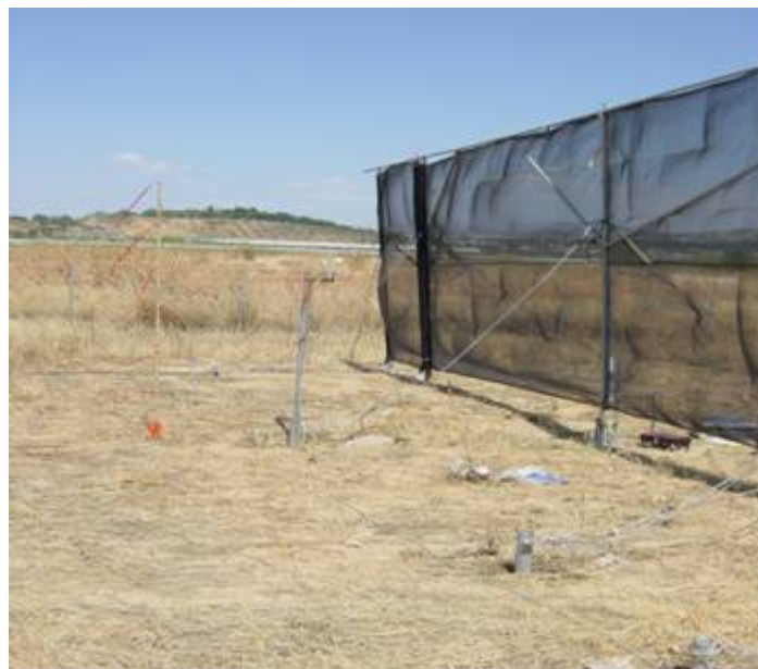
Εικόνα 26. Πλήρους κλίμακας πειραματική διάταξη πλαισίου με ελαστική στήριξη. Κάλυψη με περατό γεωργικό δίχτυ.
