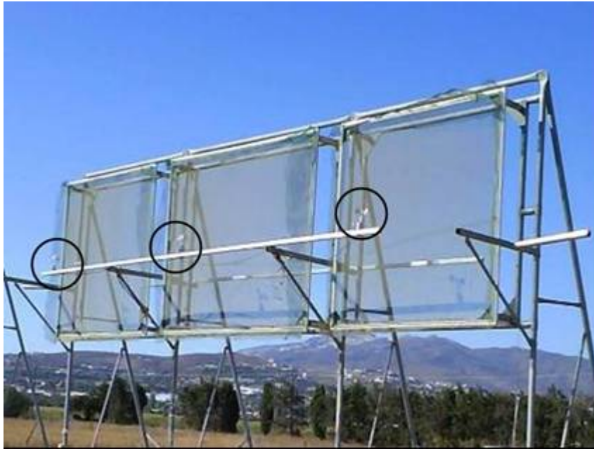
Εικόνα 9. Πείραμα πλήρους κλίμακας. Περιστροφικά ανεμόμετρα στο υπερυψωμένο πλαίσιο για την μέτρηση της ταχύτητας του ανέμου. Οι κύκλοι εστιάζουν στα τρία υπήνεμα ανεμόμετρα.
