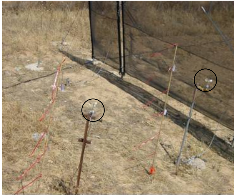
Εικόνα 31. Περιστροφικά ανεμόμετρα στην υπήνεμη περιοχή του πλαισίου ελαστικής στήριξης για τον έλεγχο της προστατευτικής ικανότητας της κατασκευής.
