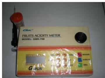
Σχήμα 2.5: Ψηφιακό οξύμετρο GMK-708
