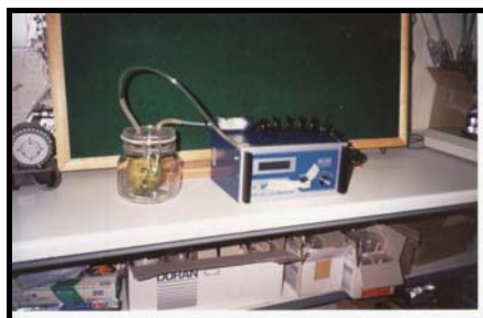
Σχήμα 2.1: Φορητή συσκευή RIKCLOS για μέτρηση της αναπνοής νωπών αγροτικών προϊόντων
