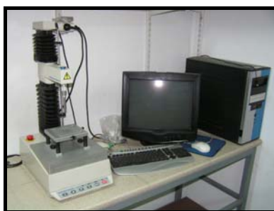
Σχήμα 2.3: Όργανο εκτίμησης της υφής νέας τεχνολογίας (Texture Analyzer)
