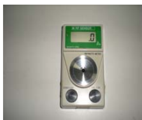
Σχήμα 2.6: Ψηφιακό διαθλασίμετρο (μοντέλο SR-400)
