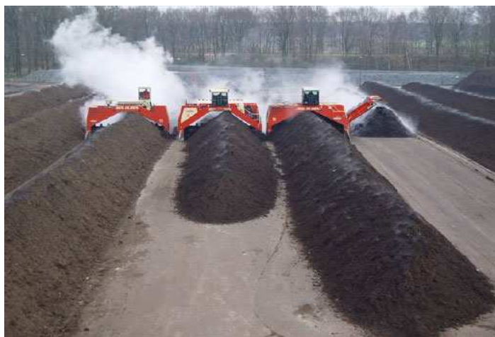
Εικόνα 1.9.2: Αναστροφή και διαβροχή γραμμικών σωρών κομποστοποίησης
