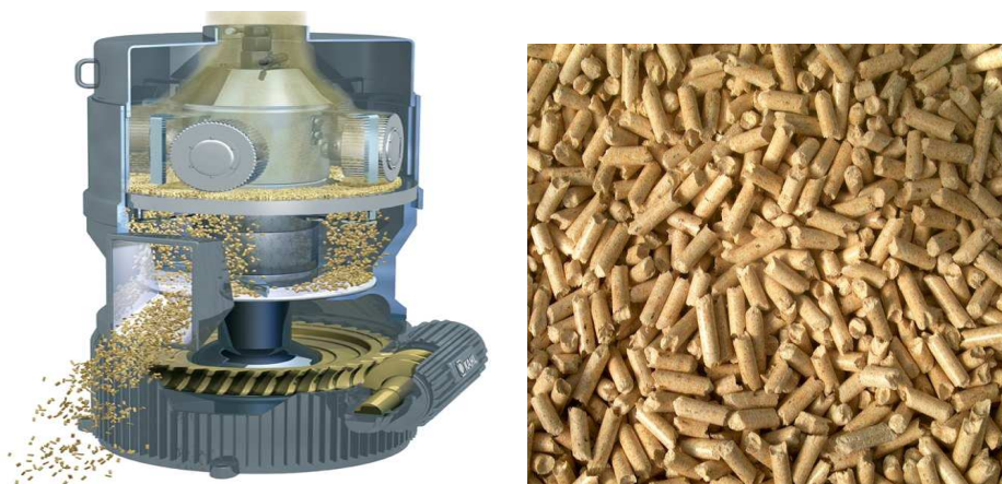
Εικόνα 4.5.3: Μηχανή πελλετοποίησης (αριστερά) - Πελλέτες (δεξιά)
