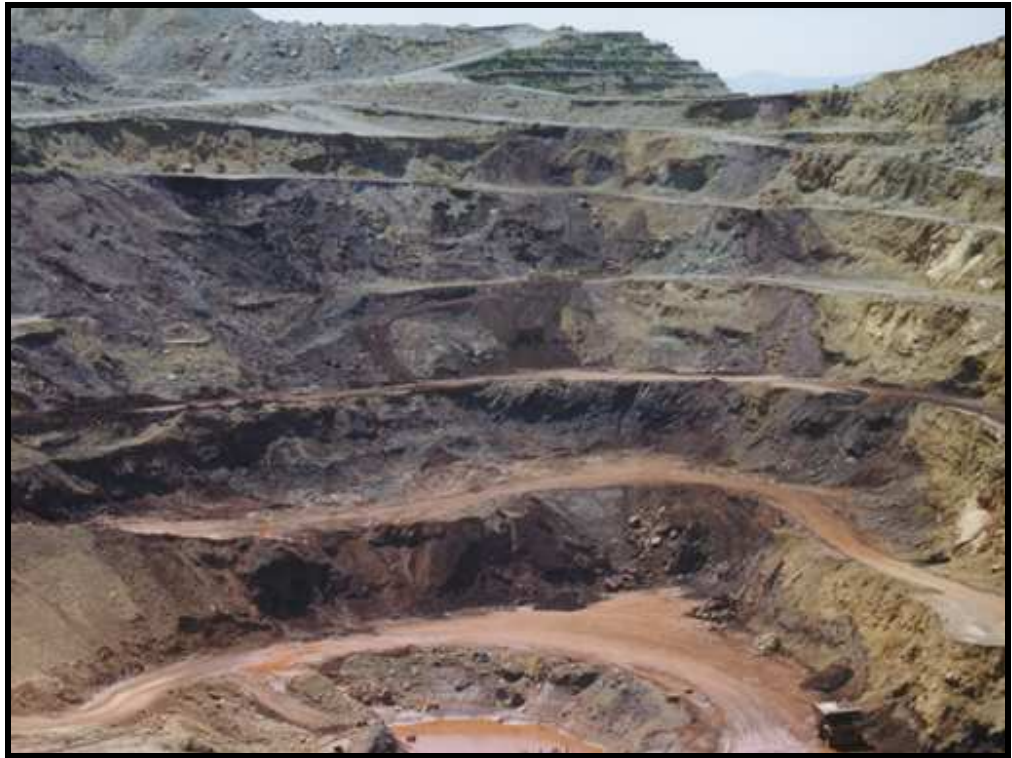
Εικόνα 7.5. Φωτογραφία (Ιούλιος 1999) του Ορυχείου Νικελίου στο Ίσωμα στη κεντρική Εύβοια. Φαίνεται καθαρά η επαφή μεταξύ των λατεριτών και των επιφανειακών άγονων (ασβεστόλιθοι). Κατεύθυνση Νοτιοανατολική.
