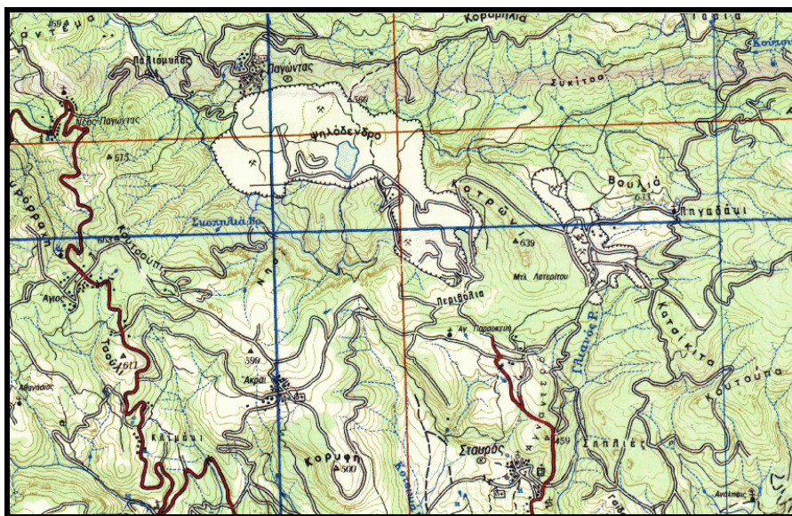
Εικόνα 9.21. Ένα υποσύνολο του γεωσυσχετισμένου χάρτη 1: 50,000 χρησιμοποιήθηκε για τη συλλογή των σημείων γεωαναφοράς. Ο χάρτης είχε παραχθεί από τη ΓΥΣ (1990) και η ονομαστική του ακρίβεια είναι 25 μέτρα XY και 10 μέτρα Z. Η άσπρη περιοχή είναι η επιφανειακή έκταση των ορυχείων της ΛΑΡΚΟ το 1990.
