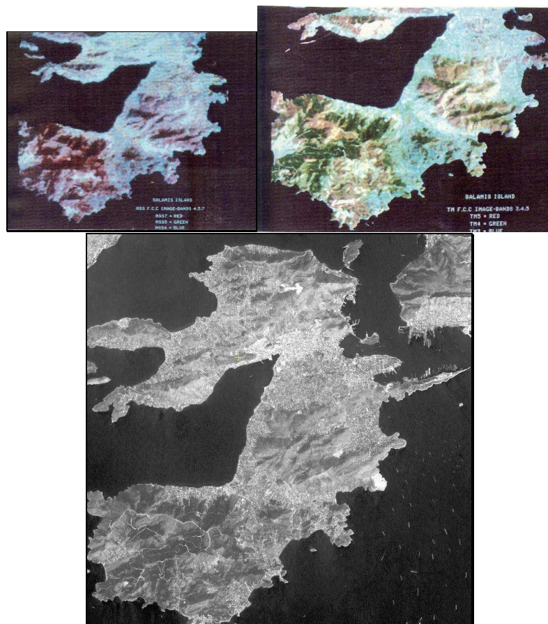
Εικόνα 3.2. Από αριστερά προς τα δεξιά και προς τα κάτω. Απεικόνιση της Ν. Σαλαμίνας από Landsat MSS (80m), Landsat TM (30m) και SPOT PAN (10m)
