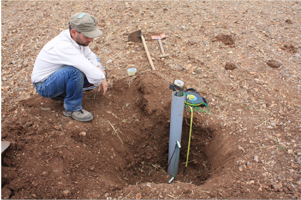
Εικόνα 9. Εγκατάσταση των αισθητήρων για τη μέτρησή της εδαφικής υγρασίας στα βάθη 30 και 60cm.
