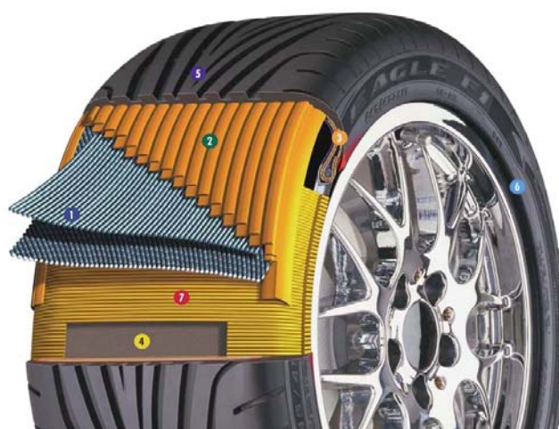
Σχήμα 1. Τομή ελαστικού αυτοκινήτου (όπου 1&2 ίνες χάλυβα και συνθετικά υλικά, 3 στεφάνη, 5 πέλμα, 6 πλευρικά τοιχώματα, 4&7 ζώνη λινών) (Πηγή: www.Auto-Internet.gr ).
