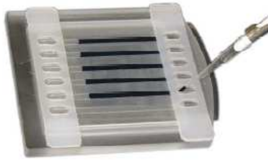
Εικόνα 2.6 : η ZOOM IPG Runner κασέτα πάνω στην οποία φορτώνεται το δείγμα πρωτεϊνών και το strip. Το δείγμα προετοιμάζεται για την ισοηλεκτρική εστίαση.
