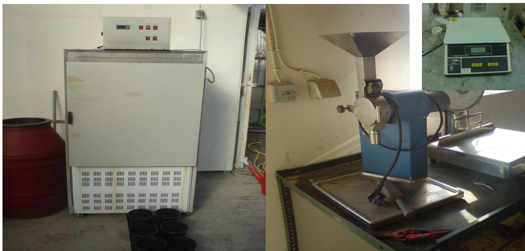
Εικόνα 15. Φούρνος ξήρασης (Mettmert, model 500) (αριστερά), μύλος ψιλοτεμαχισμού (μοντέλο Retsch, MM200) (δεξιά) και ζυγαριά ακριβείας (πάνω δεξιά).
