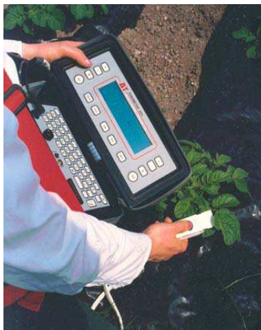
Εικόνα 16. Απεικόνιση συσκευής AP4 Porometer. (Πηγή: http://www.delta-t.co.uk )
