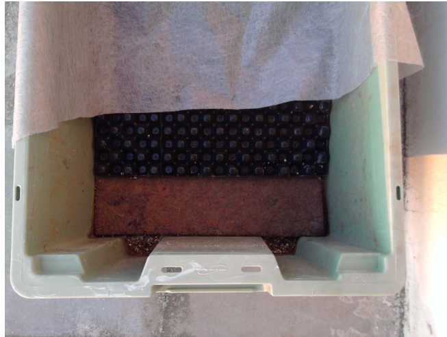
Εικόνα 10. Υλικά υποδομής φυτεμένου δώματος εντός πλαστικού κιβωτίου.
