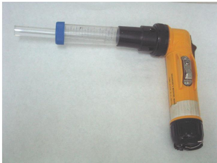
**Εικόνα 3.13.** Μηχανικός αναρροφητήρας συλλήψεως τέλειων κουνουπιών.
