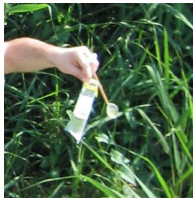
**Εικόνα 3.10.** Σακουλάκια τύπου Whirl-Pak για τη μεταφορά των δειγμάτων.
