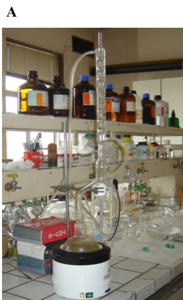
Εικόνα 4.2: Α. Υδροαπόσταξη με συσκευή Clevenger. Β. Απόσταξη-εκχύλιση με συσκευή Lickens-Nickerson.
