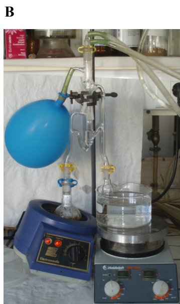
Εικόνα 4.2: Α. Υδροαπόσταξη με συσκευή Clevenger. Β. Απόσταξη-εκχύλιση με συσκευή Lickens-Nickerson.
