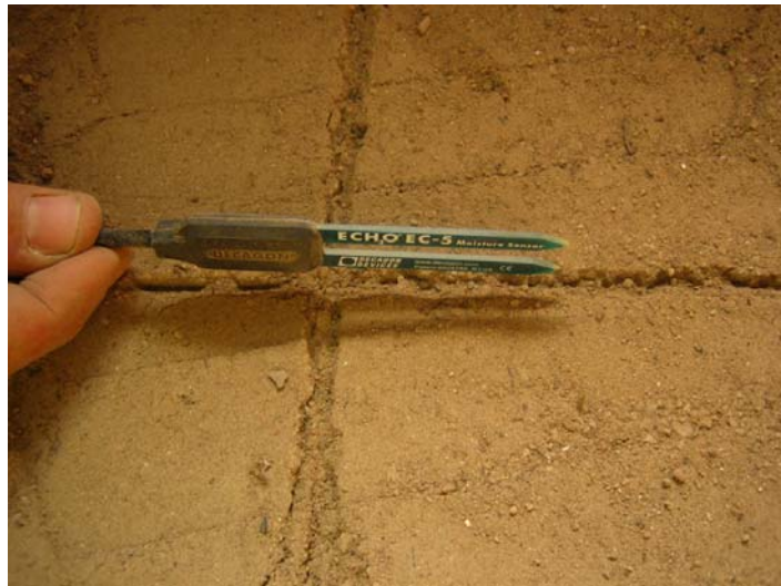
Σχήμα 14. Απεικόνιση του αισθητήρα υγρασίας EC5-Decagon Devices.
