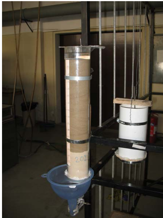
Σχήμα 10. Φωτογραφία κατά τη διάρκεια του πειράματος μονοδιάστατης κατακόρυφης διήθησης της μίξης χώματος-άμμου.
