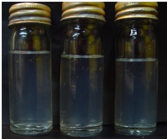
Εικόνα 18. Γυάλινα φυαλίδια με θρεπτικό μέσο στη μορφή παχύρρευστου υγρού (0,1% Αγαρόζη) για προσομοίωση συνθηκών έλλειψης οξυγόνου.
