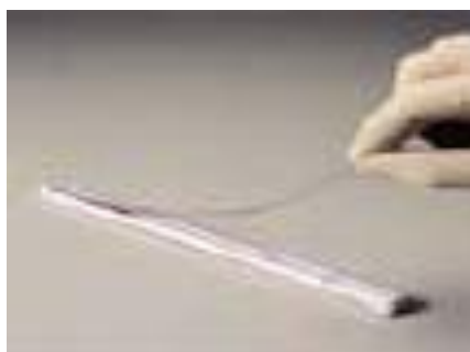
Εικόνα 1.14 Ταινία ακινητοποιημένης κλίσης pH (IPG strip). Οι ταινίες αυτές εμφανίζουν πλεονεκτήματα όπως αυξημένη επαναληψιμότητα και ικανότητα να εστιάζουν μεγάλες ποσότητες πρωτεϊνών.
