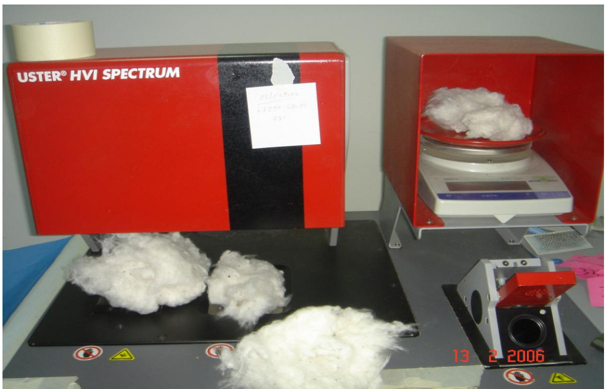
Εικόνα 16: Στη συσκευή HVI εκτιμήθηκαν τα χαρακτηριστικά ποιότητας της ίνας σε 3,500 ατομικά φυτά.
