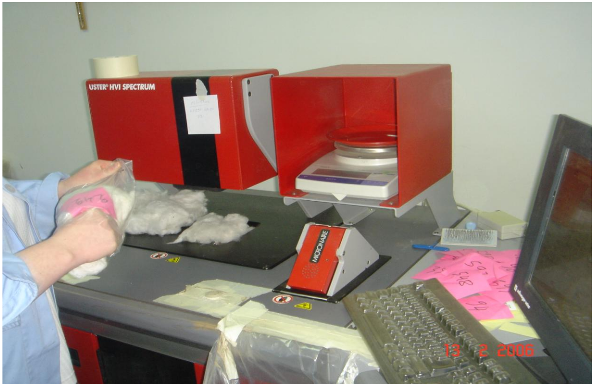
Εικόνα 15: Τα δείγματα της ίνας επεξεργάζονται στη συσκευή HVI προκειμένου να εκτιμηθούν τα χαρακτηριστικά ποιότητας της ίνας.
