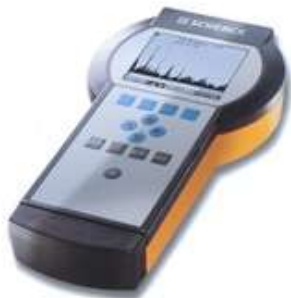
Εικόνα 9α. Φορητός αναλυτής Brüel & Kjær Vibro
