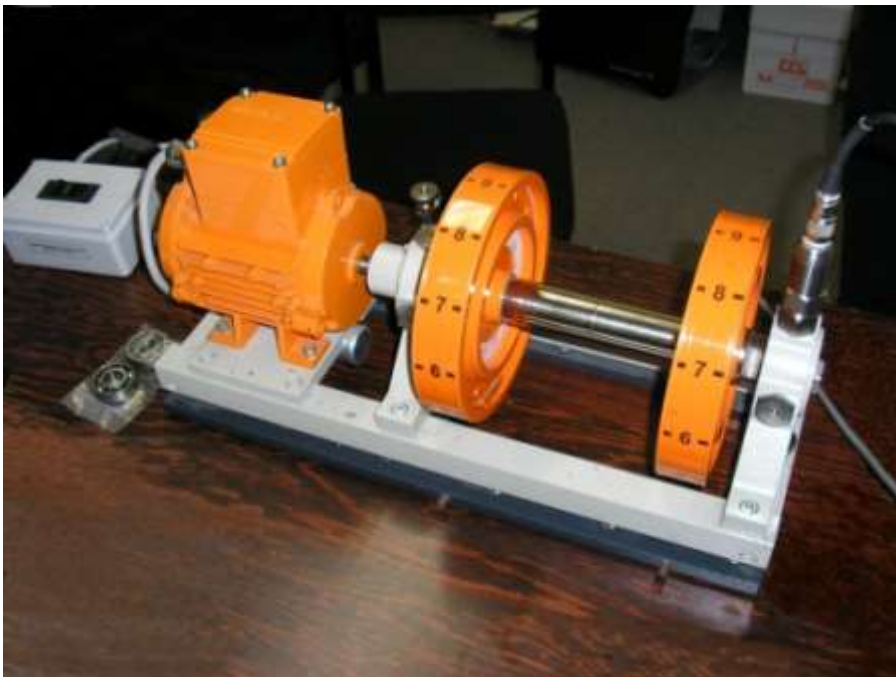
Εικόνα 77: Συσκευή εξοικείωσης Vibrotest 60.
