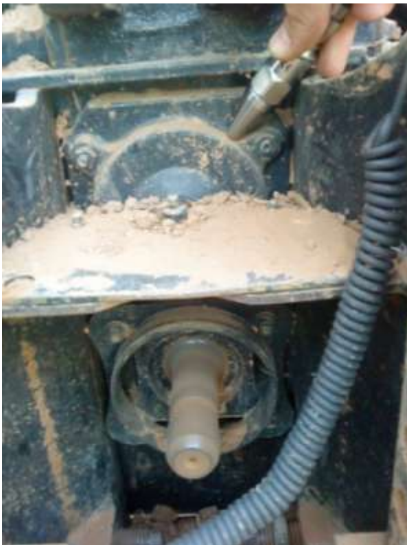
Εικόνα 73α: Έδραση με probe και μέτρηση ακτινικά.
