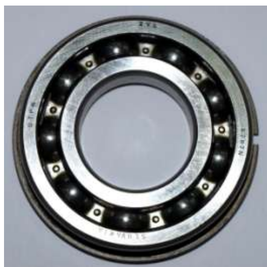
Εικόνα 68α: Το ρουλεμάν του PTO του McCormick GM50.
