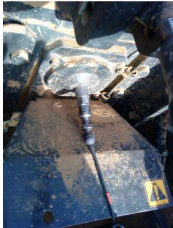
Εικόνα 73β: Έδραση με μαγνήτη και μέτρηση αξονικά.
