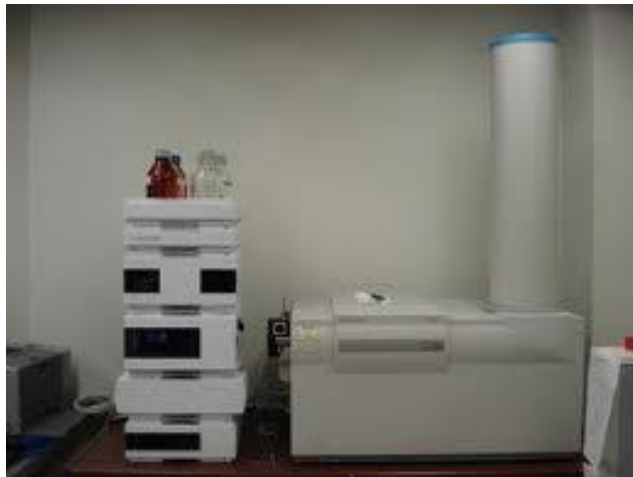
Σχήμα 5.14. Σχηματικό διάγραμμα διαδικασία διαχωρισμού ιόντων (πάνω), σύστημα φασματομετρίας μαζών χρόνου πτήσης ιόντων (Agilent 6200) (κάτω).
