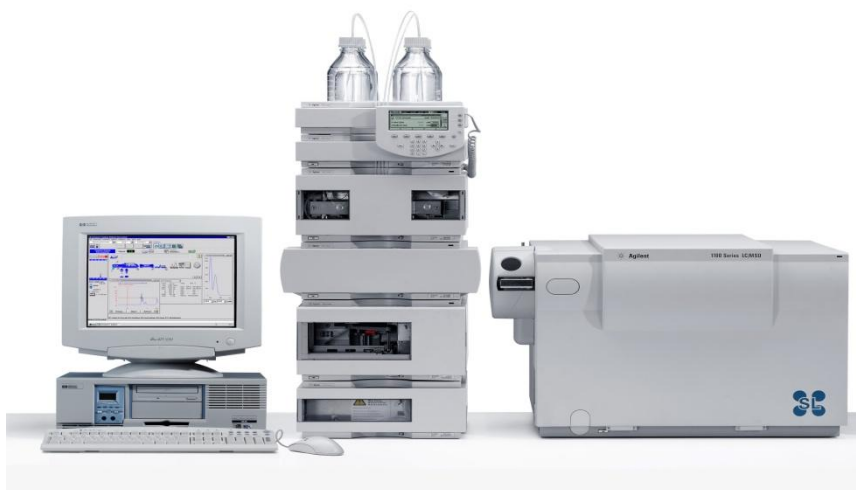
Σχήμα 5.9. Σύστημα φασματομετρίας μαζών απλού τετραπόλου σε συνδυασμό με υγρή (Agilent) (πάνω) και με αέρια (Shimatzu) (κάτω) χρωματογραφία
