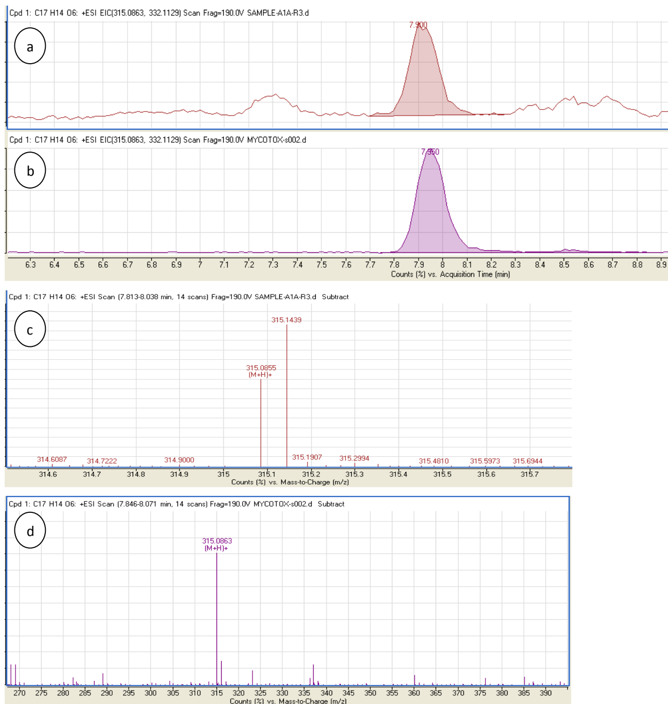
Σχήμα 7.4. LC-TOF/MS χρωματογράφημα προτύπου διαλύματος αφλατοξίνης B1 συγκέντρωσης 0,02mg/L σε διαλύτη (a) και δείγματος ζωοτροφής στην οποία ταυτοποιήται ουσία αφλατοξίνη B1 (b) Στα σχήματα (c) και (d) απεικονίζονται τα φάσματα των κορυφών της ουσίας αφλατοξίνης B1 στο πρότυπο (a) και στο δείγμα (b) αντίστοιχα.
