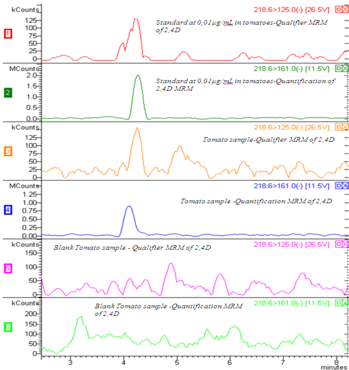
Σχήμα 6.3. LC-MS/MS χρωματογράφημα δείγματος τομάτας το οποίο περιέχει υπολείμματα του αναλύτη 2,4 D σε συγκέντρωση 0.01 mg/kg
