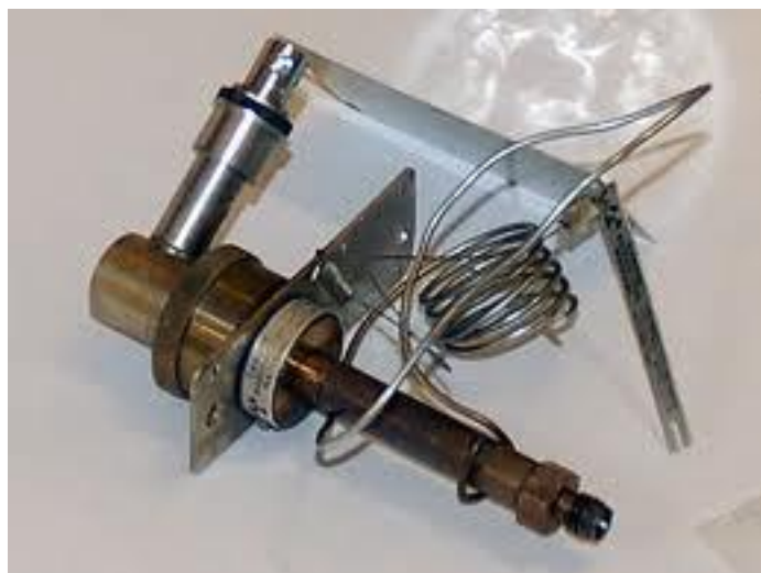
Σχήμα 5.7. Ανιχνευτής σύλληψης ηλεκτρονίων (αριστερά: σχηματικό διάγραμμα, δεξιά: ανιχνευτής ECD)
