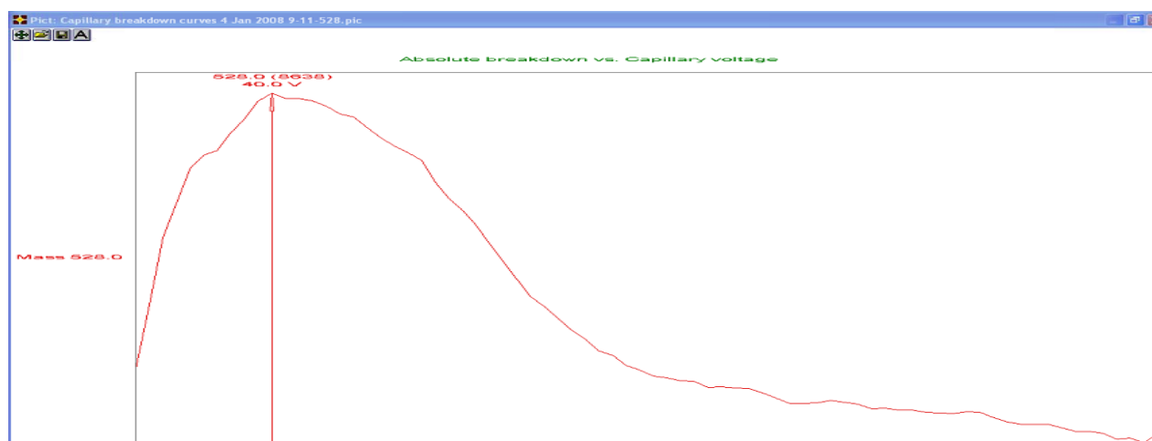
Σχήμα 5(a). Καμπύλη βελτιστοποίησης της τάσης τριχοειδούς για το ψευδομοριακό ιόν ( [M+H]^+ ) 528 του αναλύτη indoxacarb.
