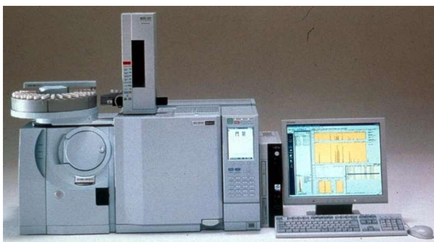
Σχήμα 5.9. Σύστημα φασματομετρίας μαζών απλού τετραπόλου σε συνδυασμό με υγρή (Agilent) (πάνω) και με αέρια (Shimatzu) (κάτω) χρωματογραφία
