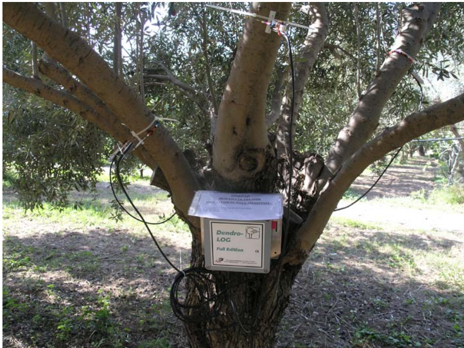
Εικόνα 3: Δενδρόμετρο με αισθητήρες τύπου DC2 και data-logger τύπου DendroLOG
