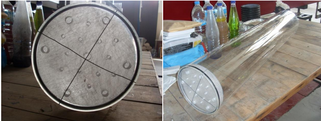
Εικόνα 12. Πυθμένας του λυσιμέτρου μετά τη προσθήκη της γεωμεμβράνης
