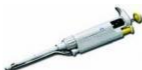
Εικόνα A-3. Αυτόματη πιπέτα μεταβλητού όγκου
