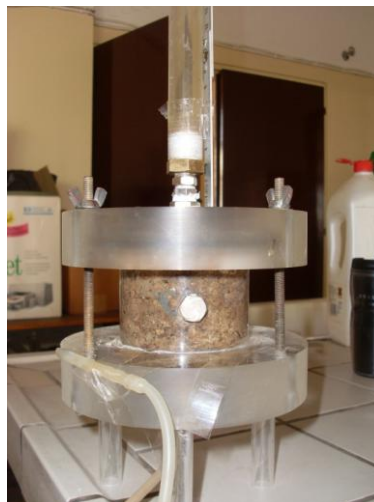
Εικόνα 15. Περατόμετρο μεταβλητού φορτίου
