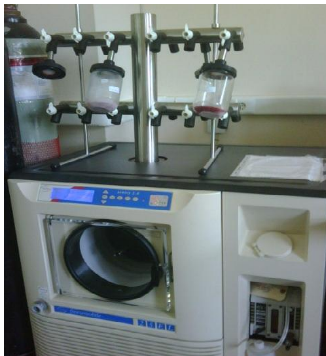
Εικόνα 2.4.2. Λυοφιλιωτής εργαστηρίου (VIRTIS 25 EL FREEMOBILE,USA).
