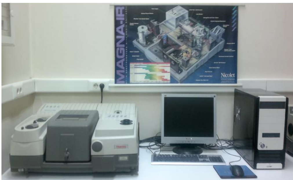
Εικόνα Β 1.3. Το σύστημα της φασματοσκοπίας υπέρυθρου που χρησιμοποιήθηκε.
