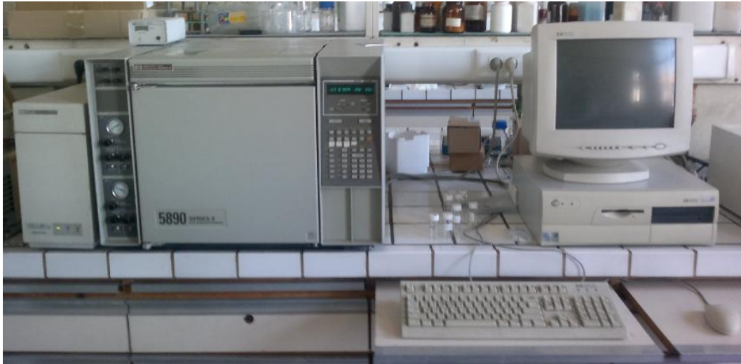
Εικόνα Β 1.2. Το σύστημα της αέριας χρωματογραφίας που χρησιμοποιήθηκε.
