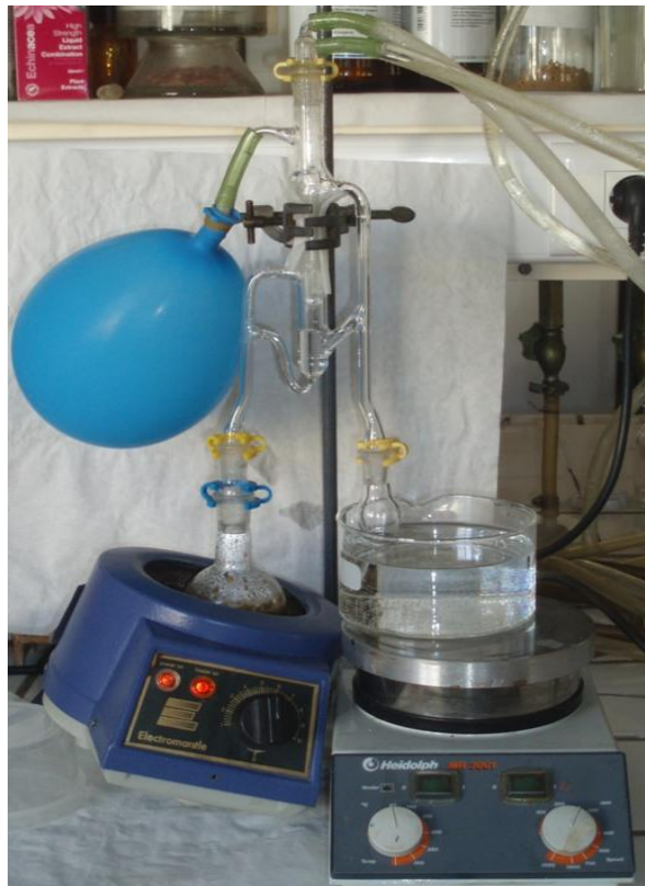
Εικόνα Β 1.1. Απόσταξη-εκχύλιση με συσκευή Likens-Nickerson.
