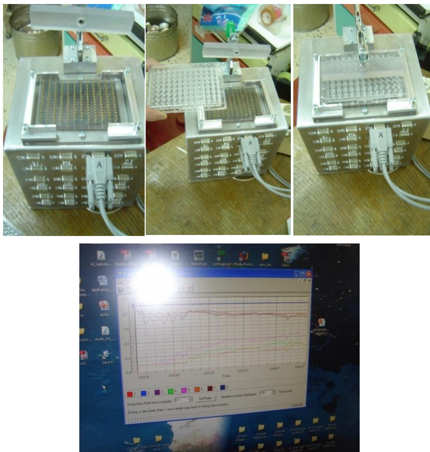
Σχήμα 3.4: Σύνδεση του βιοαισθητήρα BERA τύπου πλακιδίου ELISA με την ειδική βάση μέτρησης
