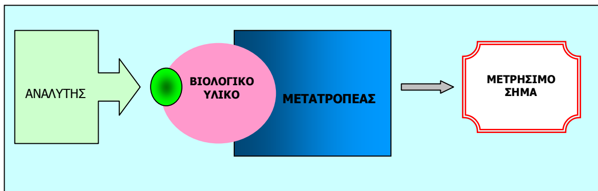
Εικόνα 1.1: Αρχή λειτουργίας βιοαισθητήρα
