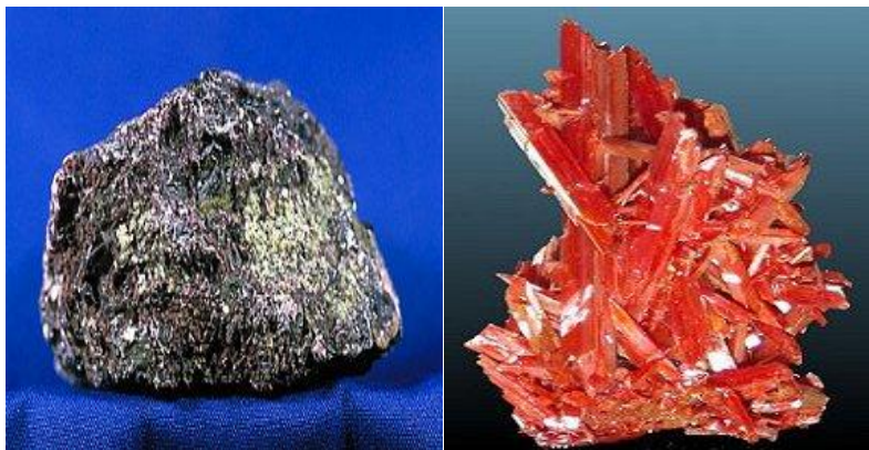
Σχήμα 2.1.: (αριστερά) Χρωμίτης \{Fe(Mg)Cr_2O_4\} ορυκτό τρισθενούς χρωμίου, (δεξιά) Κροκοΐτης (PbCrO_4) ορυκτό εξασθενούς χρωμίου http://www.chem.uoa.gr/chemicals/chem_cr6.htm
