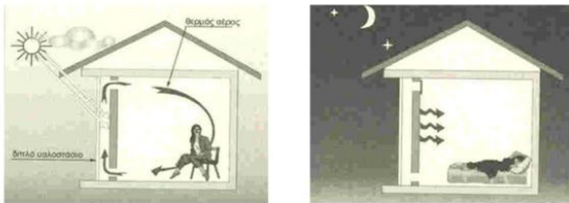
Εικόνα 1: Λειτουργία τοίχου Trombe Michel το χειμώνα.
