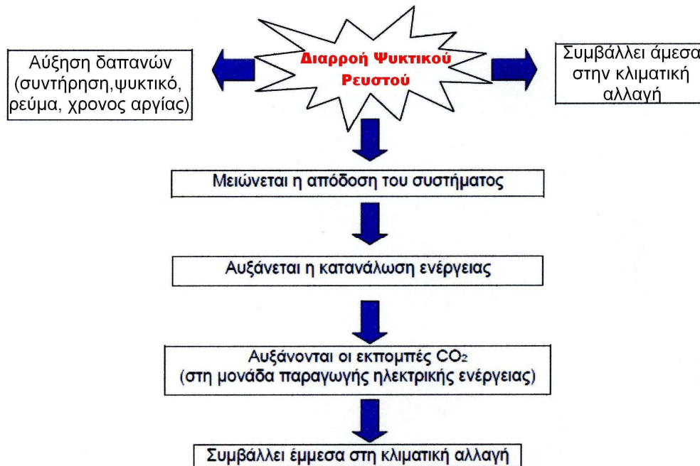
Σχήμα.1.24. Επιπτώσεις της διαρροής ψυκτικού ρευστού (Πηγή : Δάλλας, 2010).
