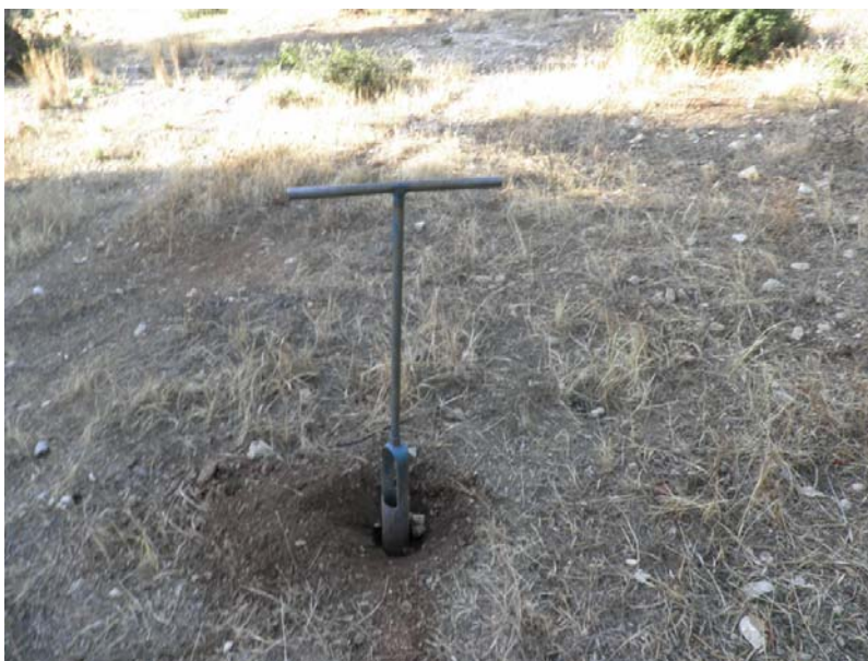
Σχήμα 7.2: Εδαφοτρυπάνη (auger) που χρησιμοποιήθηκε για τη συλλογή των δειγμάτων εδάφους.
