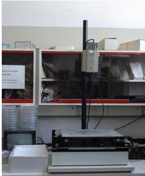
Εικόνα 15: Ο προσδιορισμός της φυλλικής επιφάνειας έγινε με τη βοήθεια της αυτόματης συσκευής DT-area meter (Delta-T Devices Ltd., Burwell Cambridge, UK).
