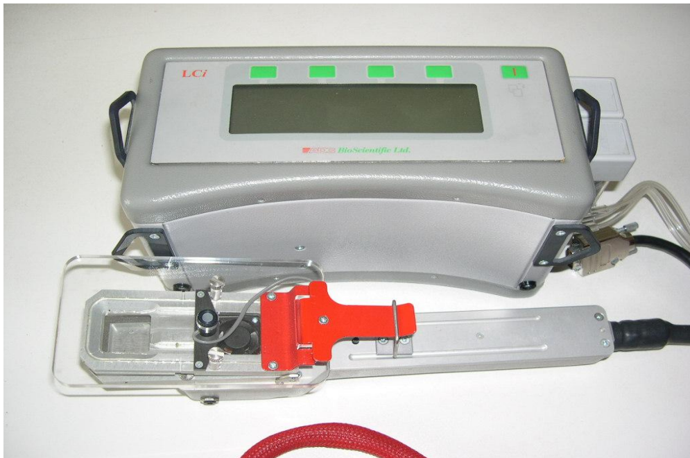
Εικόνα 16: LCI Leaf Chamber Analysis System (ADC, Bioscientific Hoddedson, UK). Το όργανο αυτό χρησιμοποιήθηκε για αρκετές μετρήσεις του πειράματος όπως για τη μέτρηση του ρυθμού φωτοσύνθεσης, του ρυθμού διαπνοής, και της αγωγιμότητας των στοματίων.
