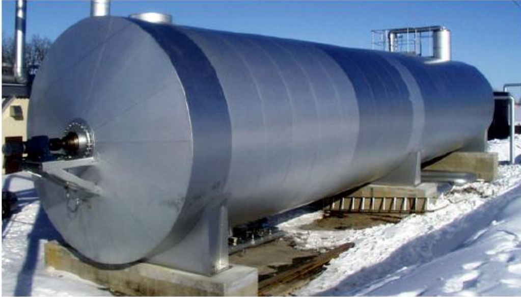
Οριζόντιος χωνευτήρας, κατασκευασμένος στην Δανία (Nordisk Folkecenter, 2001)(εικόνα 8)
