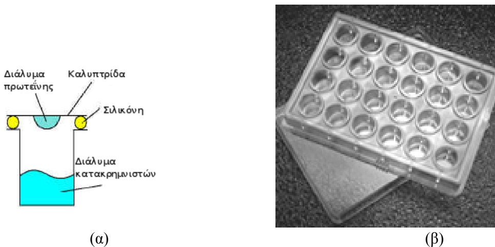
Σχήμα 2.2.α. Η αρχή της μεθόδου της κρυστάλλωσης μέσω διάχυσης ατμών με την τεχνική της κρεμάμενης σταγόνας, β. Εμπορικά πιάτα δοκιμασιών
