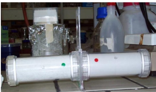
Εικόνα 3.5: Παραμονή εντόμων εντός του θαλάμου με το εντομοκτόνο για μία ώρα (θάλαμος με κόκκινη ένδειξη, αριστερά ). Παραμονή των εντόμων εντός του θαλάμου χωρίς εντομοκτόνο για 24 ώρες (θάλαμος με πράσινη ένδειξη Δεξιά ).
