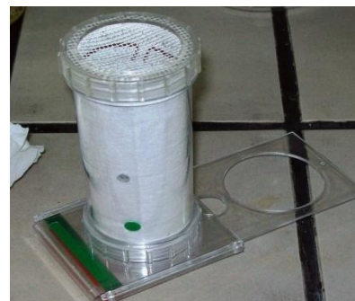
Εικόνα 3.5: Παραμονή εντόμων εντός του θαλάμου με το εντομοκτόνο για μία ώρα (θάλαμος με κόκκινη ένδειξη, αριστερά ). Παραμονή των εντόμων εντός του θαλάμου χωρίς εντομοκτόνο για 24 ώρες (θάλαμος με πράσινη ένδειξη Δεξιά ).
