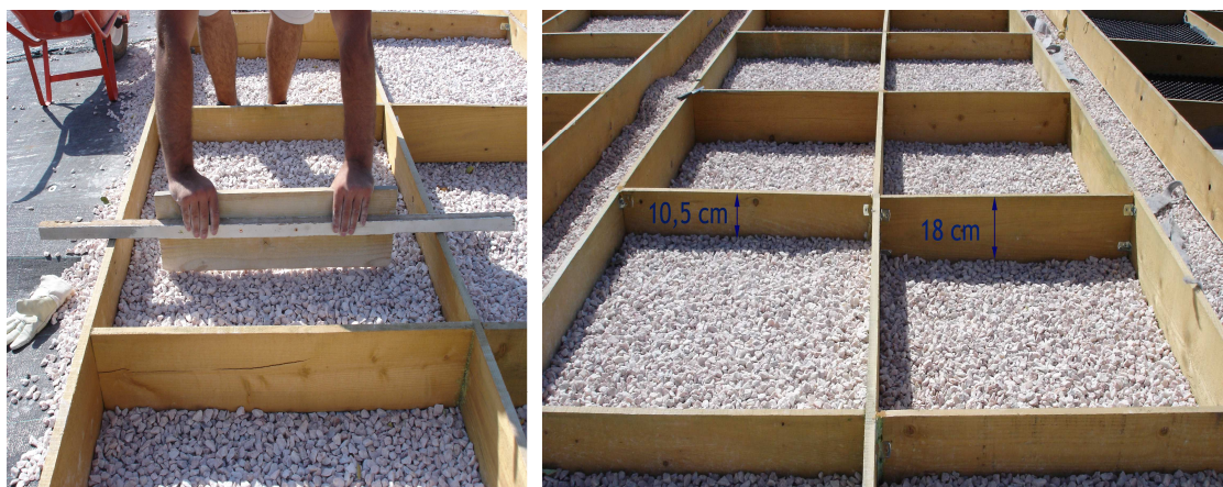
Εικόνες 3.3-3.4. Δημιουργία του βάθους του υποστρώματος με τη χρήση του χαλικιού. Στα αβαθή υποστρώματα αφέθηκε κενό 10,5 cm, ενώ στα βαθύτερα αφέθηκε κενό 18 cm από την άνω επιφάνεια των πειραματικών τεμαχίων.
