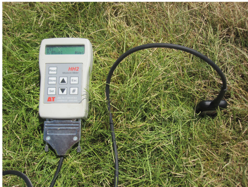
Εικόνα 3.24. Προσδιορισμός του ποσοστού υγρασίας του υποστρώματος με τη χρήση του αισθητήρα WET-2 συνδεδεμένου με το φορητό μετρητή υγρασίας HH2.
