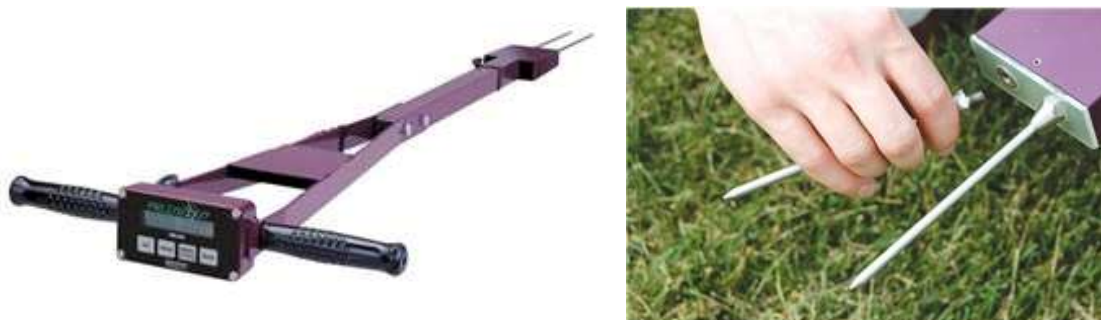
Εικόνα 2.2. Ο αισθητήρας TDR 300 και η δυνατότητα που παρέχει για εναλλαγή ραβδίων (Πηγή: www.spectrometers.com ).
