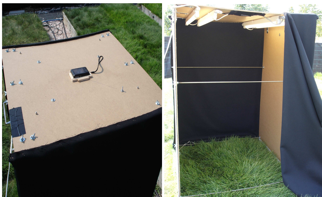
Εικόνες 3.25-3.27. Λήψη ψηφιακών εικόνων από το κάθε πειραματικό τεμάχιο, με τη χρήση ψηφιακής κάμερας τοποθετημένη στην κορυφή ενός μετακινούμενου φωτογραφικού θαλάμου. Ο θάλαμος ήταν εφοδιασμένος με 4 λαμπτήρες φθορισμού προκειμένου να διασφαλιστούν σταθερές συνθήκες φωτισμού.
