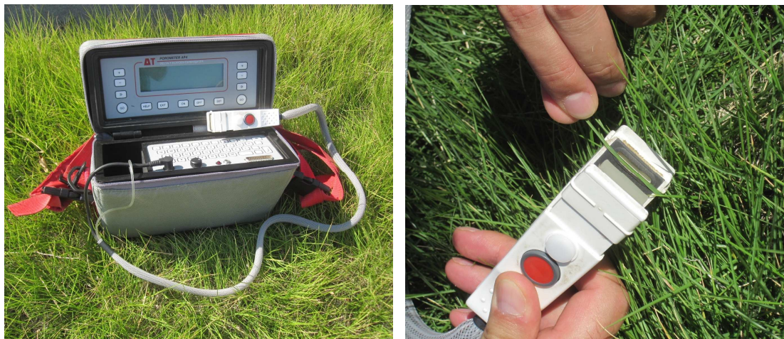
Εικόνες 3.28-3.29. Προσδιορισμός της στοματικής αντίστασης των φύλλων του χλοοτάπητα με τη χρήση πορόμετρου.
