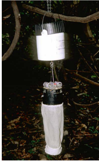
Εικόνα 18. Παγίδα διοξειδίου του άνθρακα “CO 2 - CDC trap”
