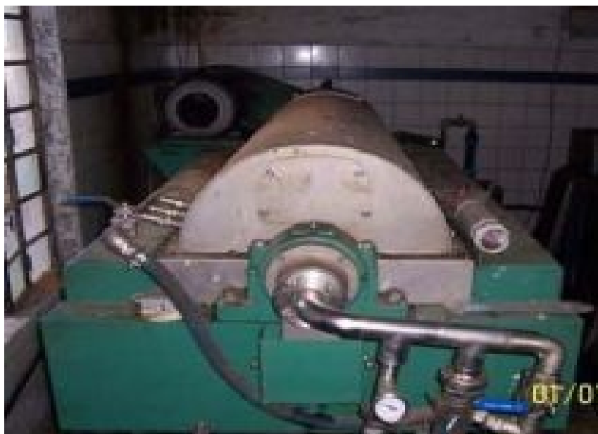
Εικόνα 1.1.2.1: Φυγοκεντρικός διαχωριστής για την εξαγωγή του ελαιολάδου ( www.prosodol.gr )
