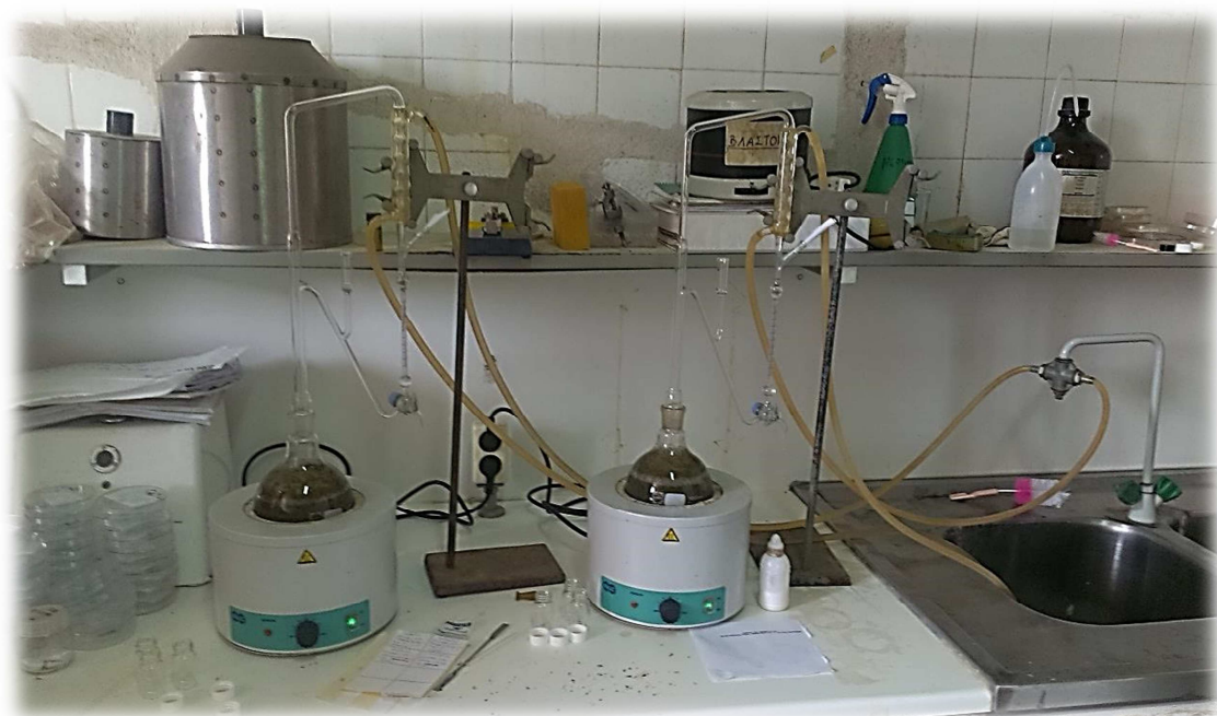
Εικόνα 7: Κατά τη διάρκεια δύο αποστάξεων με τη χρήση θερμομανδύα και συσκευής τύπου Clevenger στην ειδικά διαμορφωμένη αίθουσα του Εργαστηρίου Γεωργίας του ΓΠΑ.
