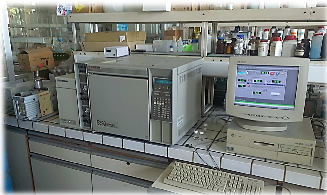
Εικόνα 8: Σύστημα GC/MS του Εργαστηρίου Γενικής Χημείας του Γ.Π.Α. που χρησιμοποιήθηκε για την ποιοτική και ποσοτική ανάλυση των αιθέριων ελαίων.
