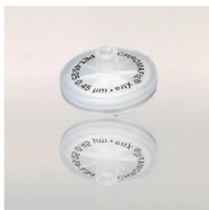
Εικόνα 13: Φίλτρο διατομής 0.45μm και διαμέτρου 25mm (Chromafil Xtra PET – 45/25).
