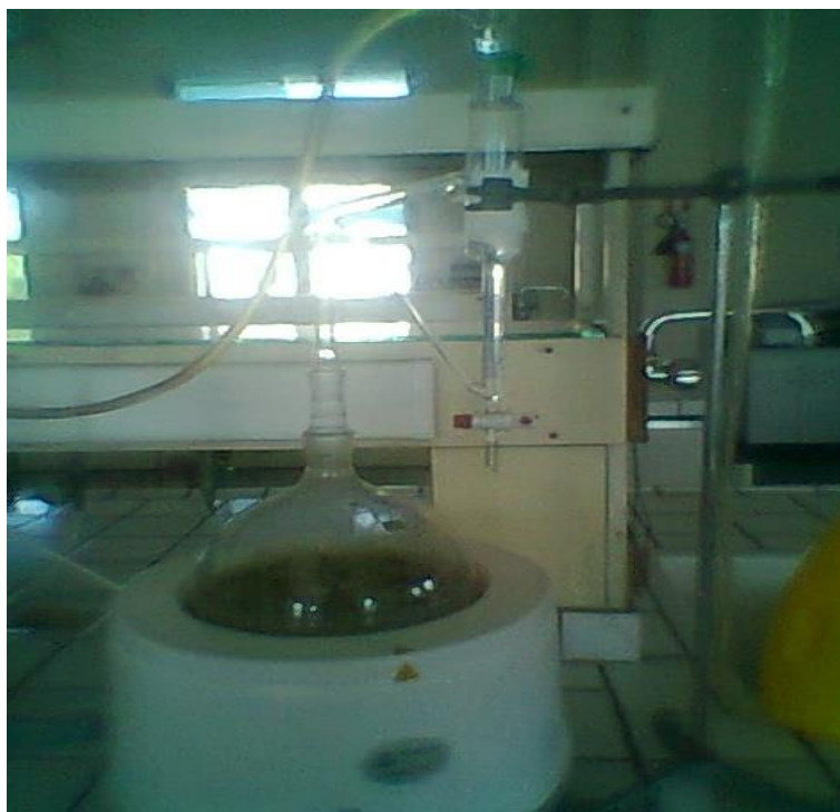
Εικόνα 4.1. Η συσκευή Clevenger (modified) που χρησιμοποιήθηκε στις υδρο-αποστάξεις.
