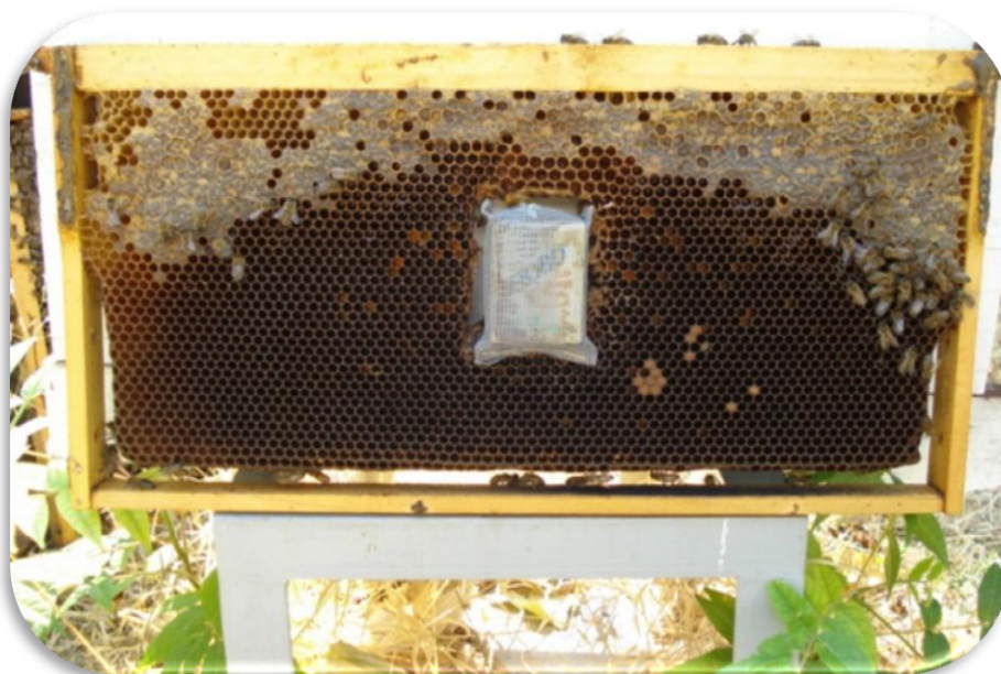
Εικόνα 42: Αυτόνομο ηλεκτρονικό καταγραφικό όργανο θερμοκρασίας και σχετικής υγρασίας (H08-004-02) προστατευμένο με σίτα και τοποθετημένο στο κέντρο της κηρήθρας.
