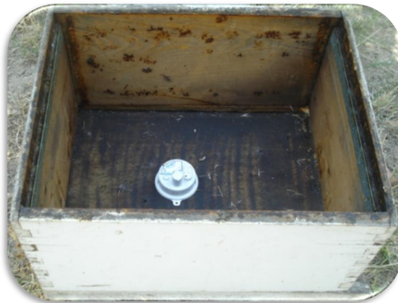
Εικόνα 44: Ηλεκτρονικό καταγραφικό όργανο θερμοκρασίας και σχετικής υγρασίας μέσα σε άδεια κυψέλη (H08-032-08).
