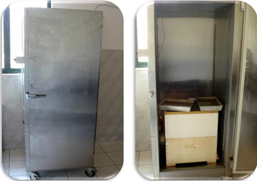
Εικόνα 37: Θερμοθάλαμος ελεγχόμενων συνθηκών ( \theta=34\pm 0,5^{\circ}\text{C} και \Sigma.Υ. = 60\pm 5\% ) όπου οι κηρήθρες στηρίζονταν σε μία άδεια κυψέλη.
