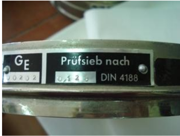
Σχήμα 5.1.3.1: Κόσκινο 0,129 mm για να συγκρατεί τη γλουτένη κατά την έκπλυση του ζυμαριού (προσωπικό αρχείο).
