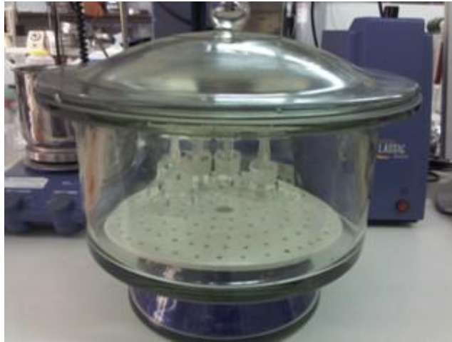
Σχήμα 5.1.2.1: Ξηραντήριο όπου τοποθετούνται τα φιαλίδια μέχρι να αποκτήσουν θερμοκρασία περιβάλλοντος (προσωπικό αρχείο).
