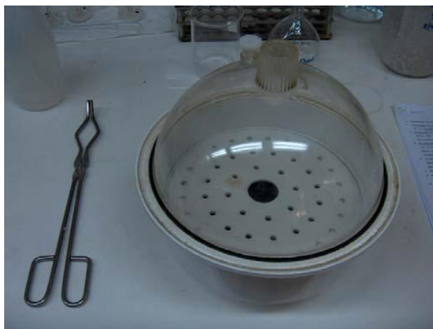
Σχήμα 5.1.1.2: Ξηραντήριο με αφυγραντικό μέσο (προσωπικό αρχείο).
