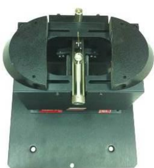
Εικόνα 2.19: Εξάρτημα για τη λήψη φάσματος με τη μέθοδο DRIFTS όπου φαίνεται η υποδοχή του micro-cup (αριστερά) και η διάταξη των κατόπτρων (δεξιά)
