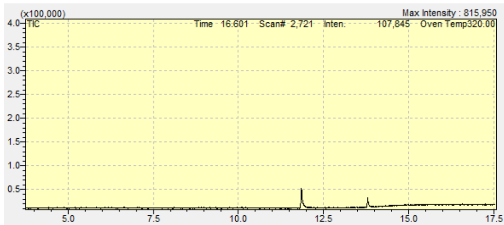
Σχήμα 8.14: Αέριο χρωματογράφημα των αναλυτών 1. Οξυφλουορφέν (oxyfluorfen), 2, διφαινυλαμίνη (diphenylamine) (200 µg/mL).
