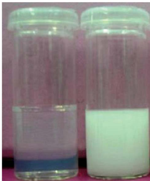
Εικόνα 6. Νανο-γαλάκτωμα πριν (δεξιά) και μετά την αναστροφή φάσεων (αριστερά) (Regev et al., 2009)
