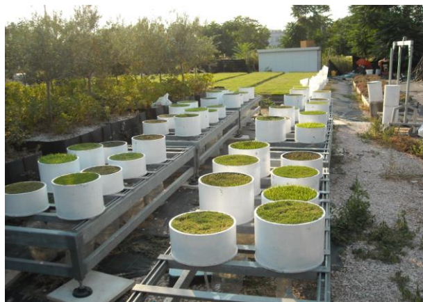
Εικόνα 4.27. Θέσης λυσιμέτρων στο πειραματικό σχέδιο.
