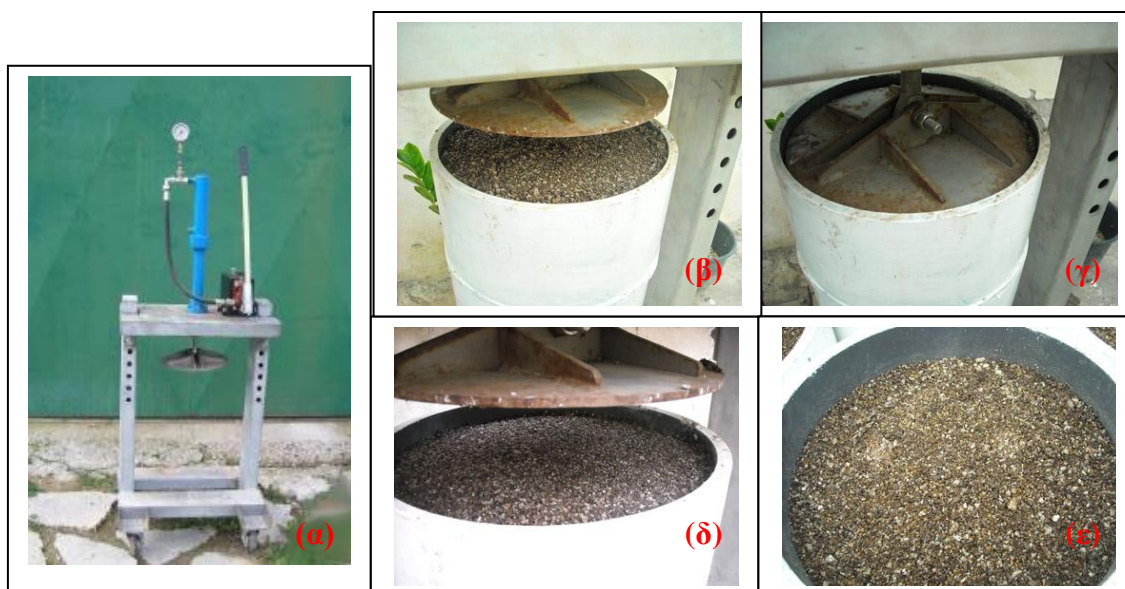
Εικόνα 4.12. α) Πρέσα. β) Τοποθέτηση λυσιμέτρων στη πρέσα. γ) Συμπύεση στα 20 bars. δ) Συμπιεσμένο υπόστρωμα. ε) Αφαίρεση περίσσειας υποστρώματος, τελική εικόνα πριν τη τοποθέτηση των γρασιδιών.
