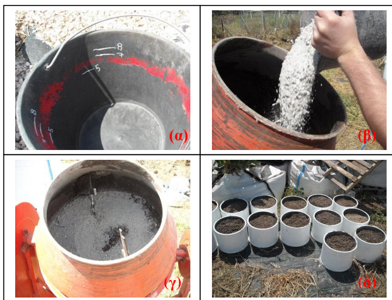
Εικόνα 4.11. α) Δοχείο ογκομέτρησης υλικών. β) Προσθήκη υλικών στον αναδευτήρα. γ) Ανάδευση υλικών. δ) Λυσίμετρα πληρωμένα με το υπόστρωμα.
