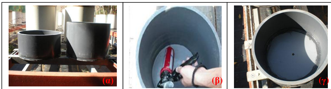
Εικόνα 4.5.. Κατασκευή και στεγάνωση λυσιμέτρων. α) Λυσιμέτρα PVC διαφορετικού ύψους 15cm και 22,5 cm. β) Εσωτερική υδατοστεγάνωση λυσιμέτρου με χρήση ακρυλικής σιλικόνης. γ) Τελική εσωτερική εικόνα λυσιμέτρου.
