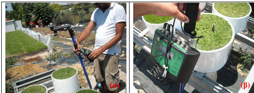
Εικόνα 4.24. α) Μέτρηση κανονικοποιημένου δείκτη διαφοράς βλάστησης (NDVI). β) Λεπτομέρεια καταγραφεία.
