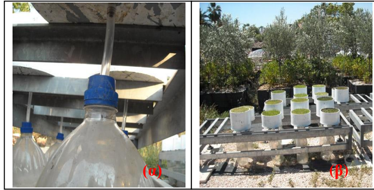
Εικόνα 4.21. α) Δοχεία συλλογής απορροών. β) Τοποθέτηση των δοχείων συλλογής κάτω από τους πάγκους.
