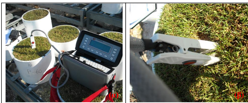
Εικόνα 4.23. α) Μέτρηση αντίστασης στοματίων. β) Λεπτομέρεια αισθητήρα .
