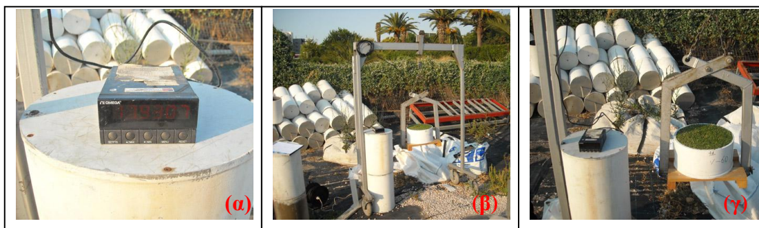
Εικόνα 4.20. Οθόνη ενδείξεων ζύγισης λυσιμέτρων. α) Σύστημα ζύγισης Load cell. β) Γέφυρα και βάση τοποθέτησης λυσιμέτρων. γ) Ζύγιση λυσιμέτρου.
