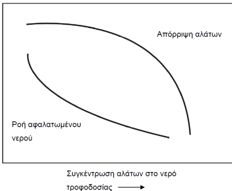
Εικόνα 6.4: Επίδραση της συγκέντρωσης των αλάτων στο νερό τροφοδοσίας στη ροή του αφαλατωμένου νερού και στην απόρριψη των αλάτων. (Πηγή: DOW, 2012)
