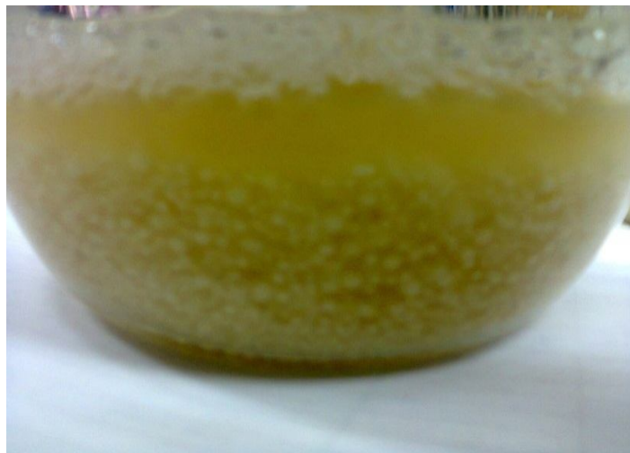
Εικόνα 3.1.1: Παραγωγή μικρών σφαιριδίων (pellets) βιομάζας κατά τη ζύμωση του μύκητα R. arrhizus NRRL 2582 σε υπόστρωμα σακχαρόζης
