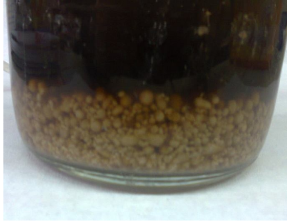
Εικόνα 3.3.1: Μορφή σφαιριδίων (pellets) κατά τη ζύμωση του μύκητα R. arrhizus NRRL 2582 σε μελάσα 25 \text{ g}\cdot\text{L}^{-1} (ισοδύναμα γλυκόζης)
