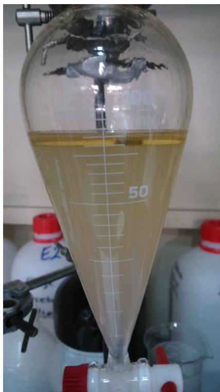
Εικόνα 2.7 . Διαχωρισμός των δύο φάσεων, στην επάνω φάση που βρίσκεται το εξάνιο εκχυλίζονται οι μεθυλεστέρες των λιπαρών οξέων.
