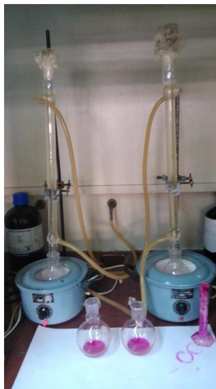
Εικόνα 2.7 . Διαχωρισμός των δύο φάσεων, στην επάνω φάση που βρίσκεται το εξάνιο εκχυλίζονται οι μεθυλεστέρες των λιπαρών οξέων.
