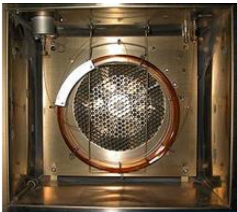
Εικόνα26. Κλίβανος στήλης συστήματος αέριας χρωματογραφίας.
