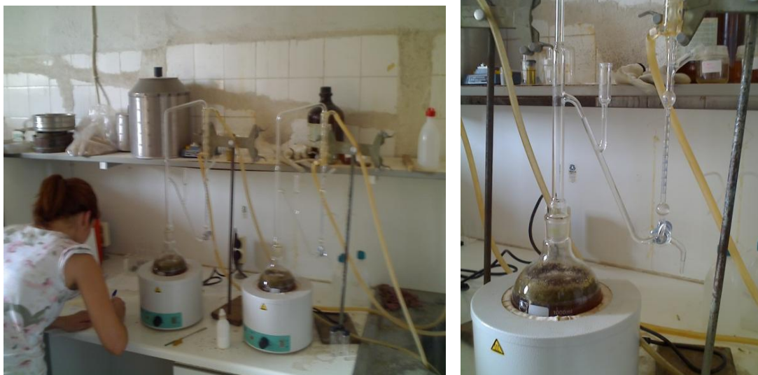
Εικόνα 36. Συσκευή Clevenger. Εξέλιξη υδροαπόσταξης στο φυτό C. capitatus στο Εργαστήριο Γεωργίας.
