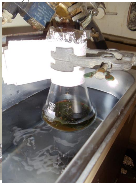
Εικόνα 41. Διαδικασία παραλαβής αιθέριου ελαίου με τη μέθοδο των υπερήχων.
