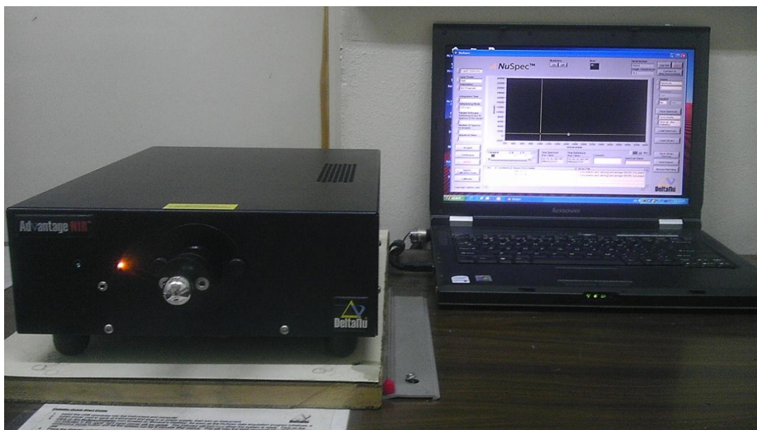
Εικόνα 3.3: Το σύστημα Raman που χρησιμοποιήθηκε στις αναλύσεις
