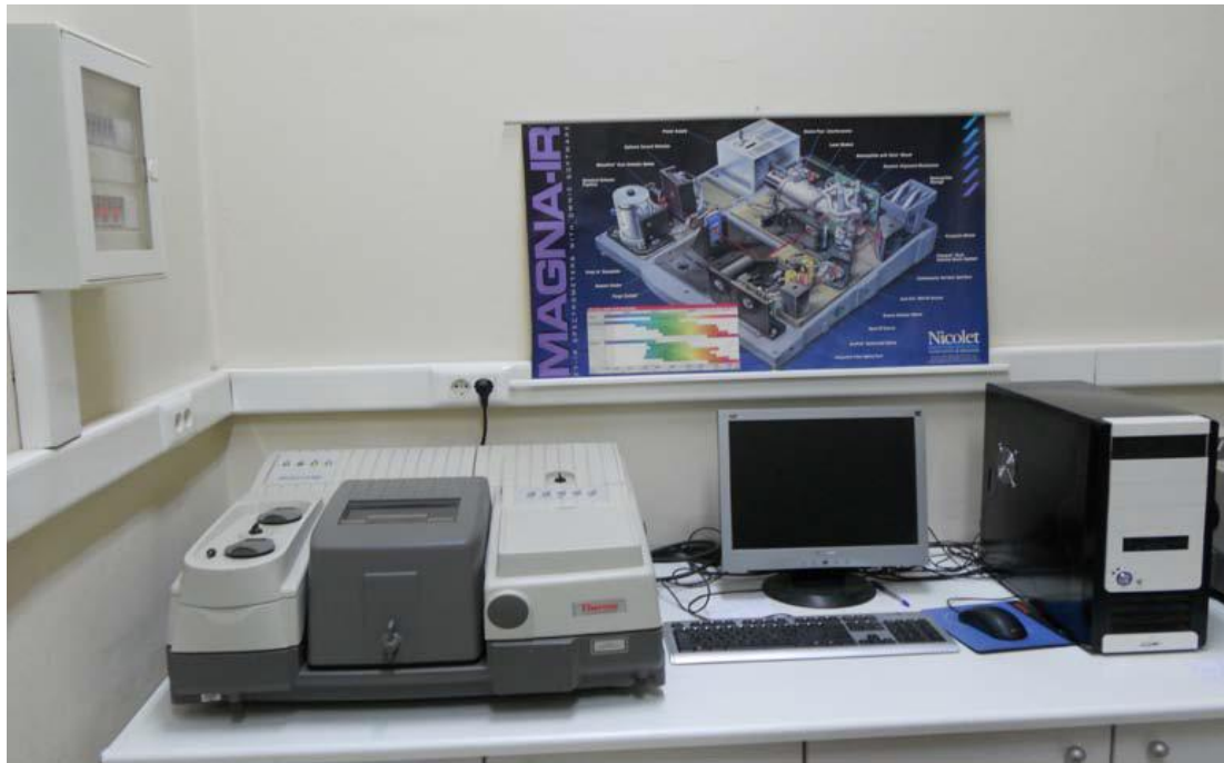
Εικόνα 3.2: Το σύστημα IR που χρησιμοποιήθηκε στις αναλύσεις
