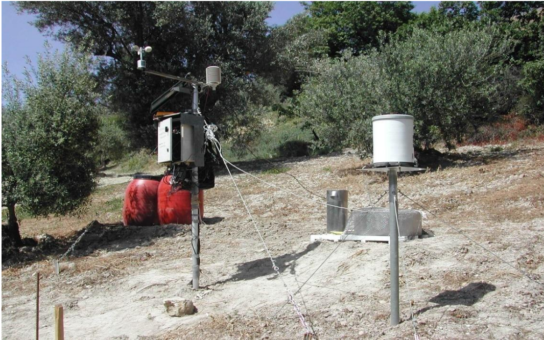
Εικόνα 2: Μετεωρολογικός σταθμός και αυτόματος τηλεελεγχόμενος ηλεκτρονικός καταγραφέας δεδομένων εγκατεστημένος κοντά στο χωριό Αυγενική του νομού Ηρακλείου.
