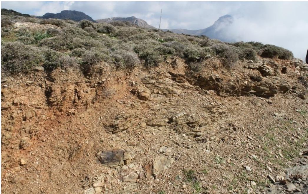
Εικόνα 4: Φωτογραφία τομής του εδάφους του πειραματικού τεμαχίου όπου γίνεται φανερή η εναλλαγή αργιλικού και ψαμμιτικού φλύσχης.
