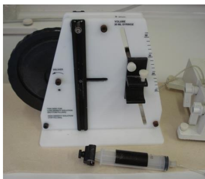
Εικόνα 4.3.7.3 Συσκευή Βαθμίδωσης Συγκέντρωσης
