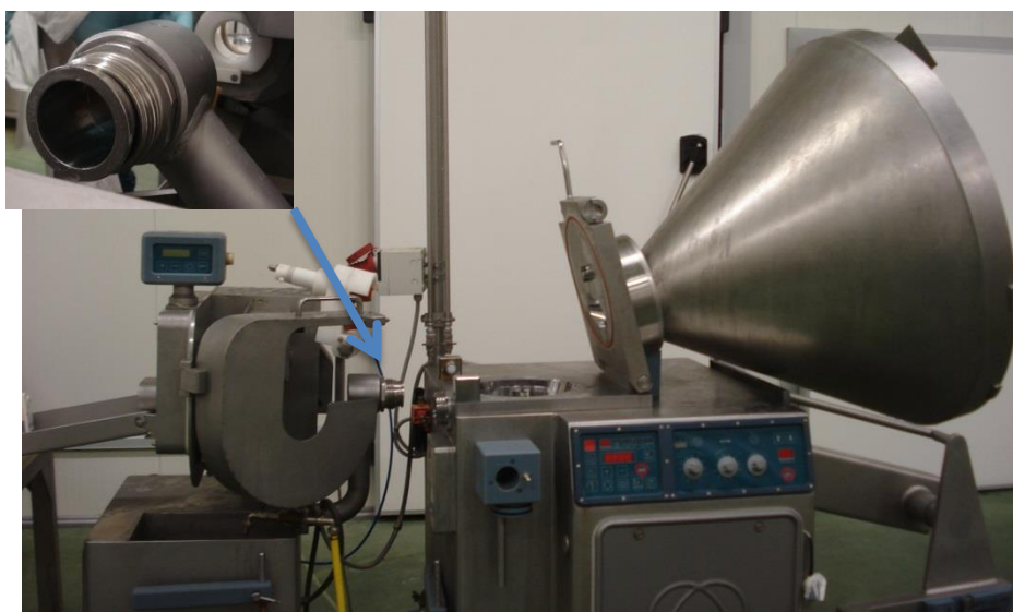
Εικόνα 5.1.2 Σωλήνας Διασταύρωσης για την Ενθήκευση των Σαλαμιών
